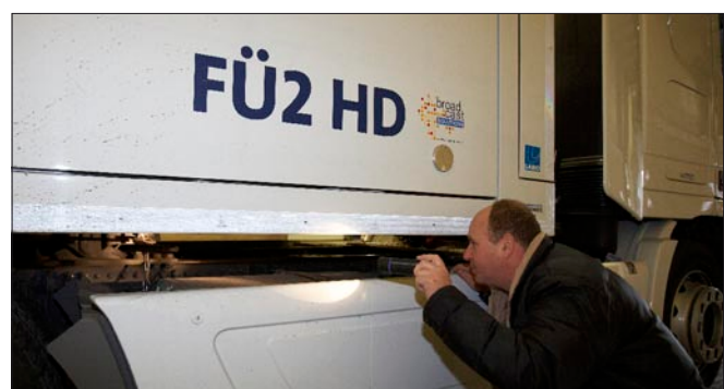
Die Kontrolle der Sattelkupplung gehört zum Pflichtprogramm unterwegs.
